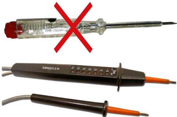
Abb. 22 Ein- und mehrpolige Phasenprüfer
